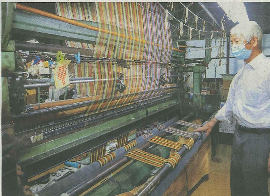
松井ニット独特の風合いで生む低速ラッセル編み機。戦後間もない時代から動くこの機械の扱いが困難で、事業承継の壁となっている
